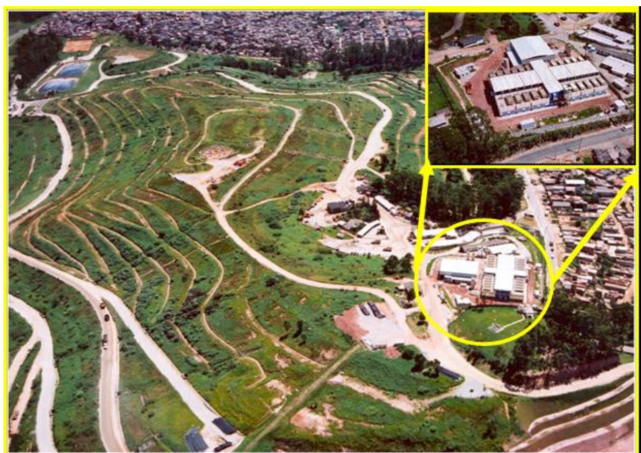
Figura 18 – Vista aérea do Aterro dos Bandeirantes de São Paulo (SP) com detalhe da Usina Termelétrica (UTE) de Biogás.
