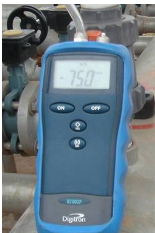
Figura 32 – Manômetro da Digitron® usado no presente trabalho no monitoramento da pressão dos poços de extração de biogás (PB).
