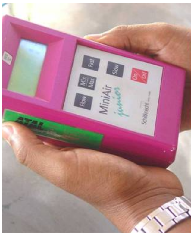
Figura 31 - Anemômetro da Schiltknecht ® usado na medição da vazão da extração de biogás nos poços (PB) monitorados.
