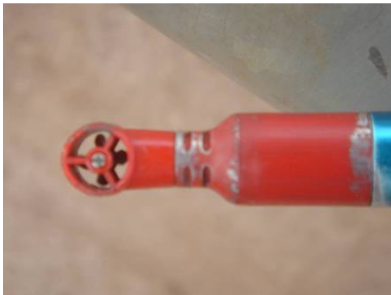
Figura 30 – Detalhe da hélice do Anemômetro da Schiltknecht® usado no presente trabalho no monitoramento da velocidade do gás em cada Poço de Biogás (PB).
