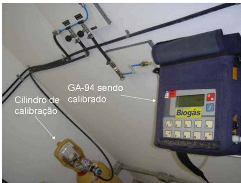
Figura 29 - Analisador de biogás da Geotechnical Instruments ® sendo calibrado com o cilindro padrão antes de ser usado para medir a qualidade do gás em campo.
