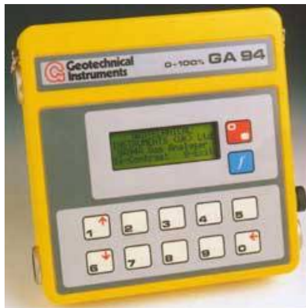
Figura 27 – Analisador de biogás da Geotechnical Instruments ® usado no presente trabalho no monitoramento da qualidade do gás (metano e oxigênio) em cada Poço de Biogás (PB).
