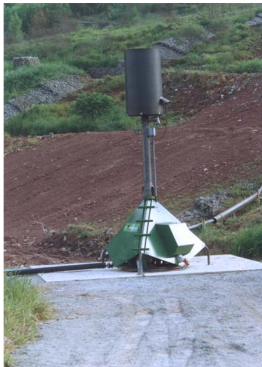
Figura 21 – Mini-Flare (queimador) usado nos testes feitos pela USEPA em 1997. Fonte: Van der Wiel Stortgas .
