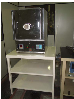
FIG. 54: Forno de sinterização modelo FE1600-INTI. (EEL-USP-DEMAR)
