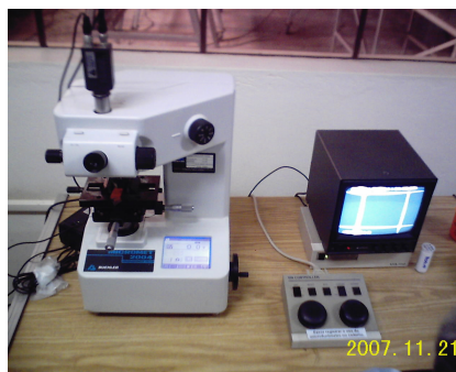
FIG. 58: Microdurômetro Micromet 2004 modelo 1600-4988 - Buehler (EEL-USP-DEMAR).
