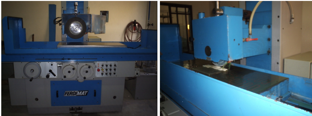
FIG. 55: Retífica automática FERDIMAT modelo TA-104A, utilizada para preparação superficial de amostras sinterizadas. (EEL-USP-DEMAR).
