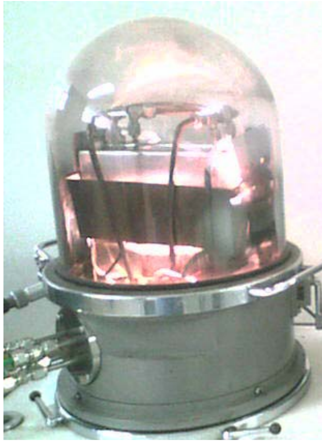
FIG. 4.12 Sistema de deposição por CSS em funcionamento
