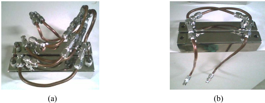
FIG. 4.5 Tubos de cobre para refrigeração dos aquecedores da a)Fonte e do b) substrato
