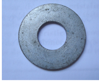
FIG. 3.5 – Fotografia da matriz metálica utilizada na preparação dos filmes “testemunho” das resinas
