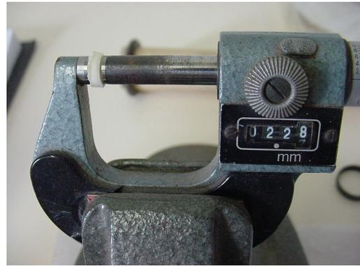
FIGURA 4.13 – Micrômetro utilizado para medição da espessura das amostras
