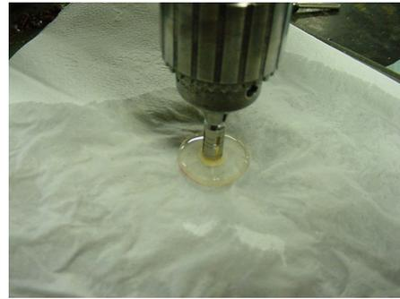
FIGURA 4.7 - Remoção da amostra com a trefina
