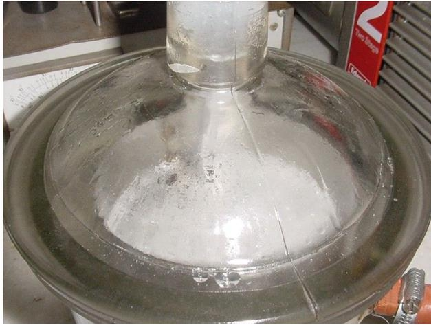
FIGURA 4.29 – Inundação com xylol do recipiente contendo as amostras
