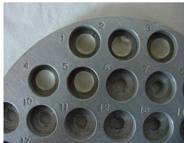
FIGURA 4.26 - Bandeja para impregnação das amostras com xylol
