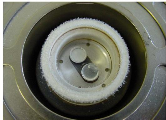
FIGURA 4.33 – Detalhe dos aquecedores do aparelho DSC Q10 com os dois cadinhos
