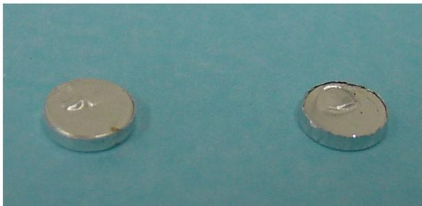
FIGURA 4.32 - Cadinhos com amostras já prensadas
