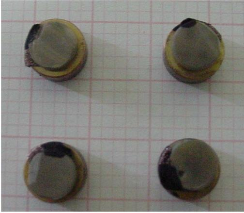
FIGURA 4.34 – Colagem das amostras nos stubs
