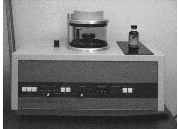
FIGURA 4.35 – Metalizador utilizado
