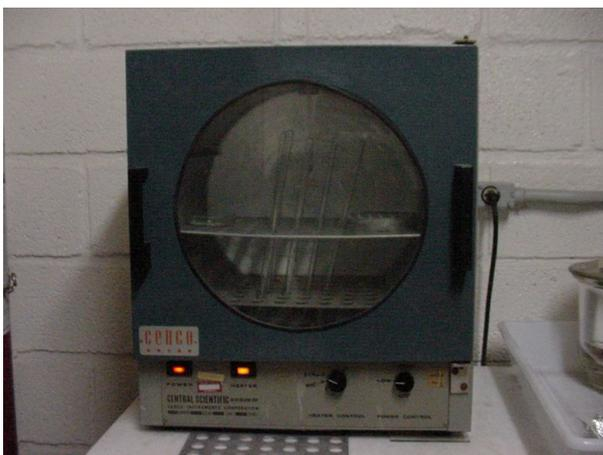
FIGURA 4.25 – Secagem das amostras em estufa a 60°C
