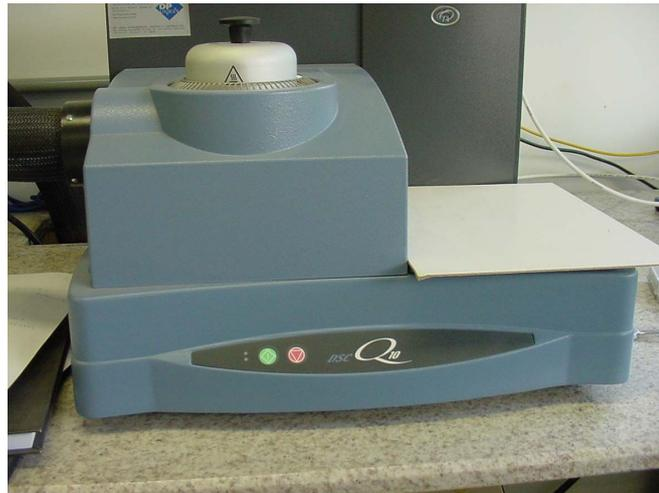
FIGURA 4.31 – Aparelho usado para a medição do calor específico
