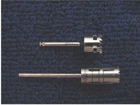
FIGURA 4.10 – Trefinas com diâmetro de 8 mm utilizadas no estudo
