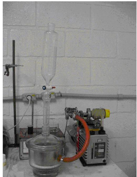
FIGURA 4.28 - Sistema para impregnação das amostras com xylol
