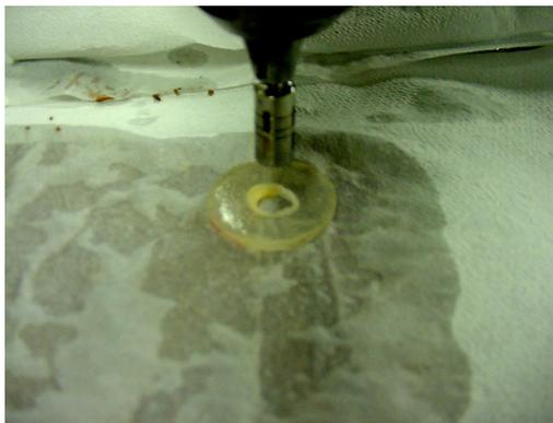
FIGURA 4.8 – Remoção da amostra do corte transversal
