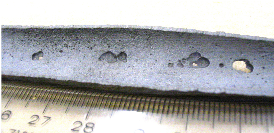
Figura 3.7 – Detalhe de tubo de aço carbono apresentando corrosão por pits e furo. (fonte: autor)
