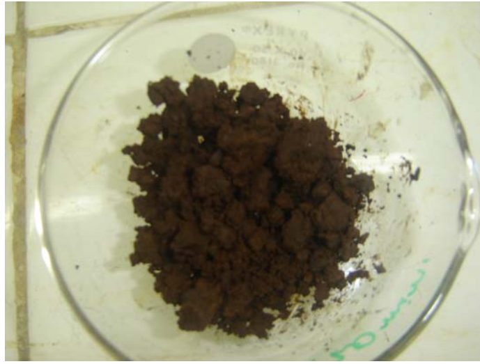
Figura 4.4 – Amostra do LETA seco à temperatura ambiente ( w = 70\% )
