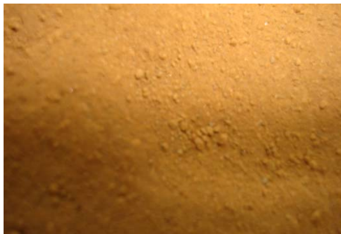
Figura 4.8 – Amostra do LETA destorroado e seco à temperatura ambiente (ampliação)
