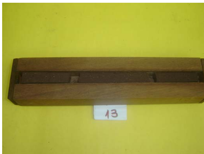
Figura 5.3 – Amostra nº 13 [LETA-100% / Pó de pedra-100% / Cal -8% / PAA-3% / Sulfato de cálcio -5%]
