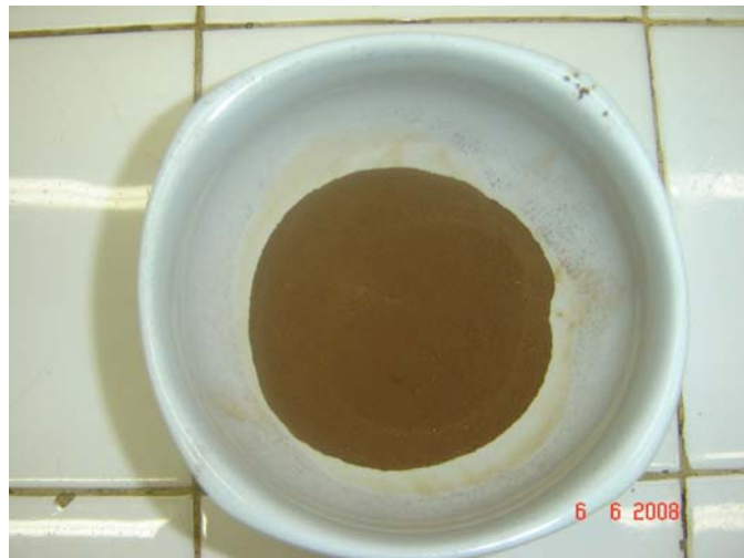
Figura 4.7 – Amostra do LETA destorroado e seco à temperatura ambiente
