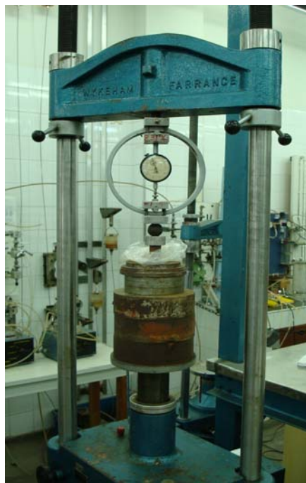
Figura 4.17 – Ensaio de Resistência a Compressão Simples
