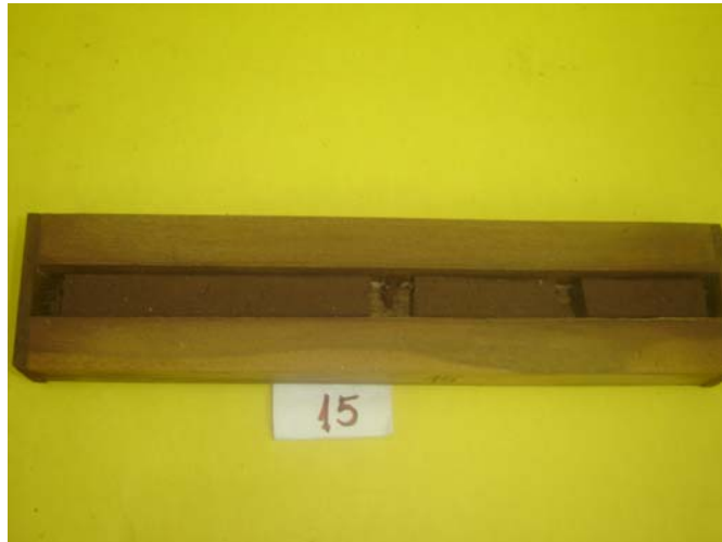
Figura 5.4 – Amostra nº 15 [LETA-100% / Pó de pedra-100% / Cal-5% / PAA - 3% / Sulfato de cálcio -10%]
