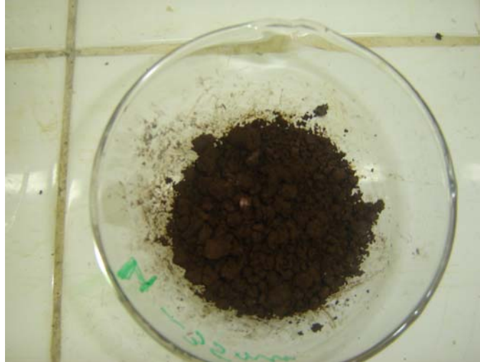
Figura 4.6 – Amostra do LETA seco à temperatura ambiente ( w = 30\% )
