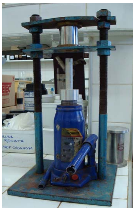
Figura 4.15 - Macaco hidráulico utilizado para extração do corpo de prova
