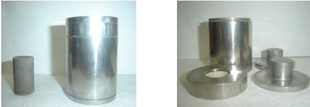
Figura 4.14- Cilindro utilizado para a moldagem dos corpos de prova (2x4)cm.
