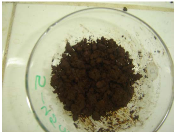
Figura 4.5 – Amostra do LETA seco à temperatura ambiente ( w = 40\% )
