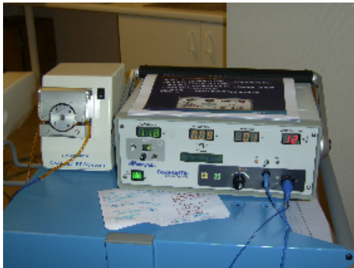
Figura 4: Gerador de corrente RF (direita) e bomba de água fria (esquerda).
