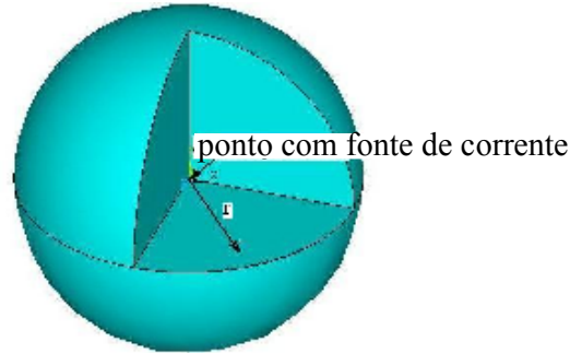
Figura 9: Esfera infinita com um ponto de fonte de corrente elétrica no centro.
