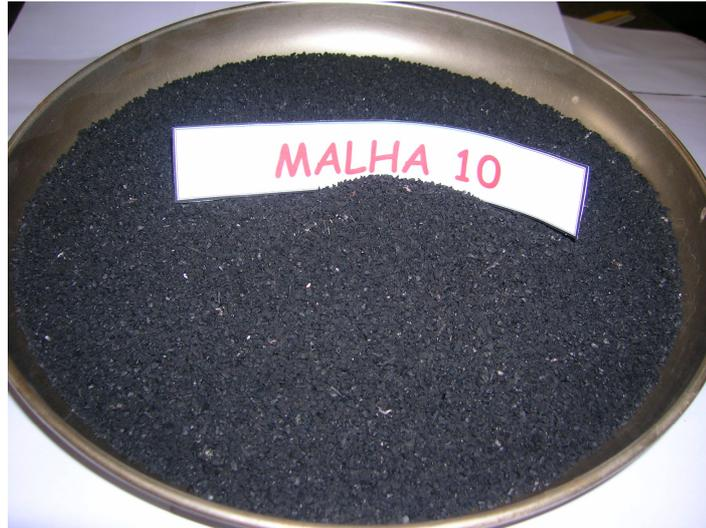
**Figura 19** - Amostra para o ensaio de análise granulométrica da borracha.
