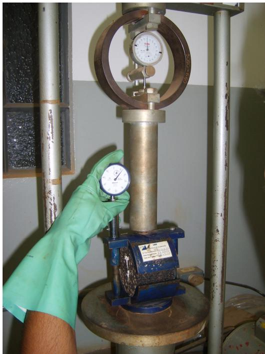
**Figura 41** - Ruptura do corpo-de-prova.
