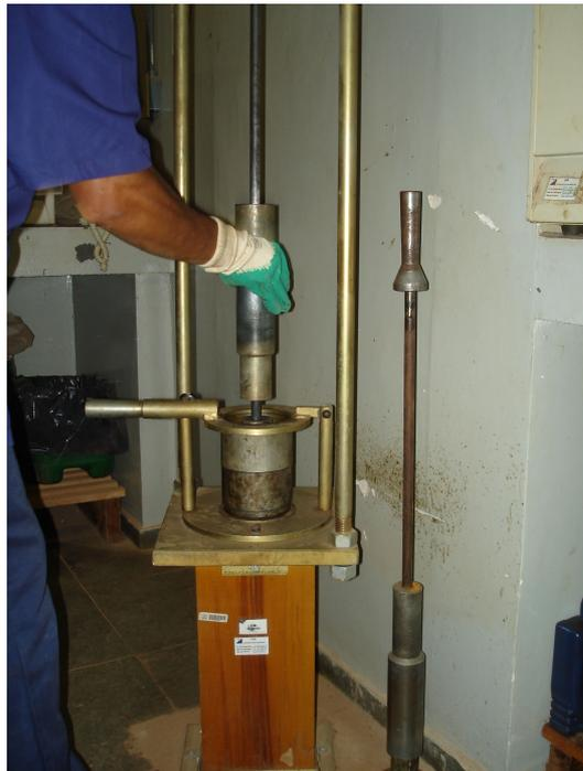
**Figura 39** - Compactação do corpo-de-prova.
