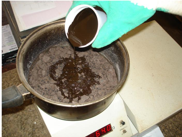
**Figura 36** - Adição do ligante ao agregado.
