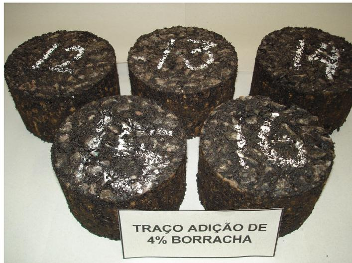
**Figura 29** - Identificação dos corpos-de-prova moldados (12 a 16) do traço com adição de 4 % de borracha.
