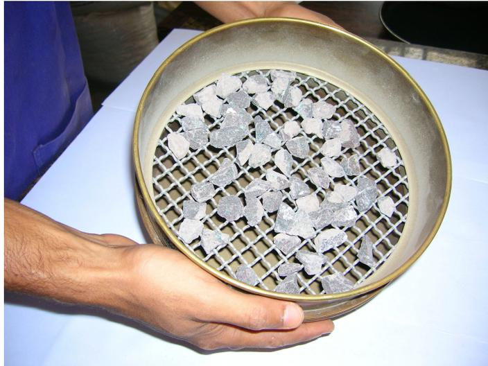
**Figura 15** - Exemplo de uma análise granulométrica de agregado graúdo.
