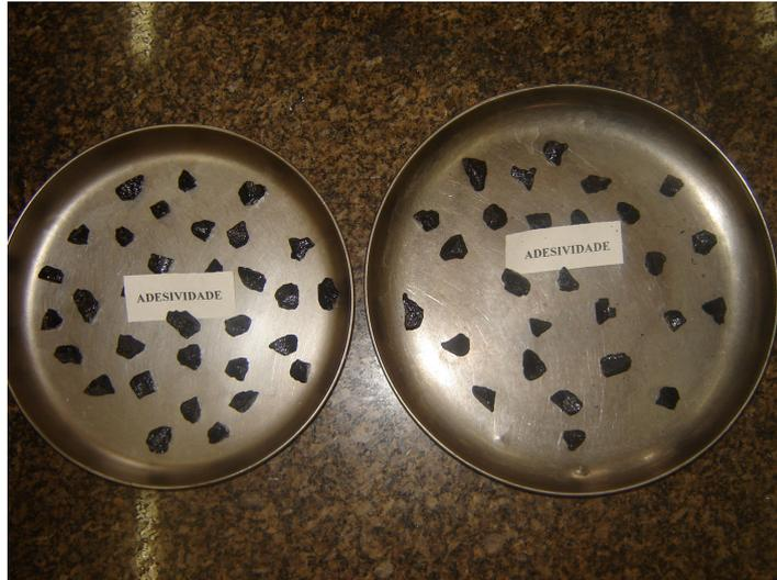
**Figura 22** - Amostras de agregado para o ensaio de adesividade.
