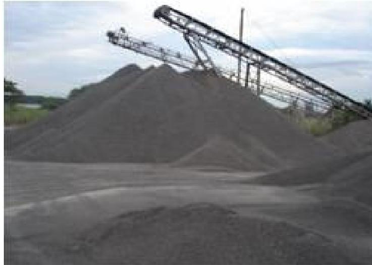
**Figura 13** - Armazenamentos de agregados graúdo e miúdo da Pedreira Ubarana.
