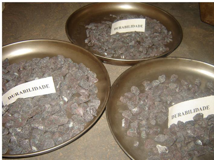
**Figura 21** - Amostras de agregado para o ensaio de avaliação da durabilidade.
