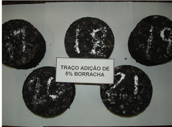
**Figura 30** - Identificação dos corpos-de-prova moldados (17 a 21) do traço com adição de 5 % de borracha.
