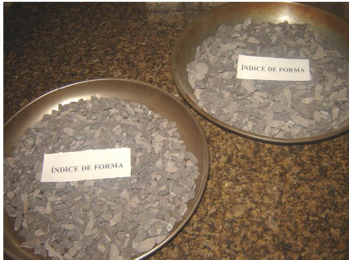
**Figura 17** - Exemplo de agregado para o ensaio de índice de forma.
