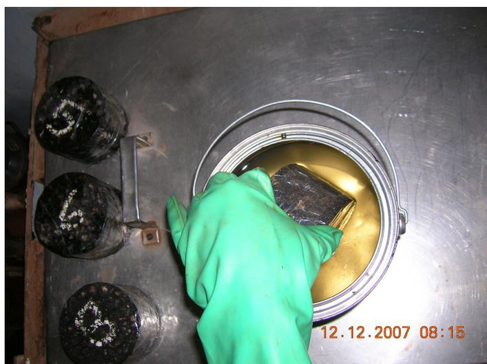
**Figura 31** - Aplicação da parafina fluidificada nos corpos-de-prova.
