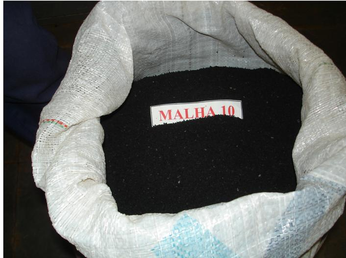
**Figura 14** – Amostra da borracha moída.
