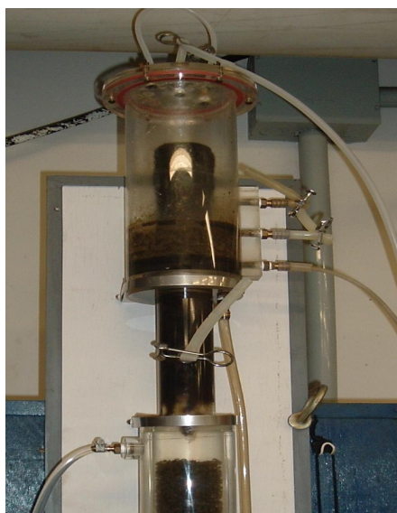
Figura 3.4 – Topo do reator (Câmara de captação de gás e dispositivo para saída do efluente).
