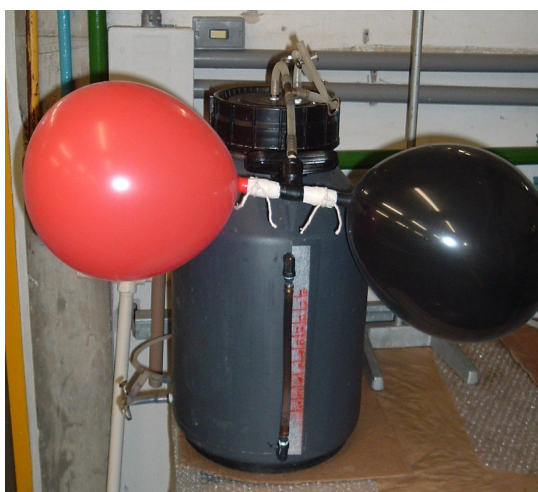
Figura 3.5 – Reservatório de alimentação (Barrilete).
