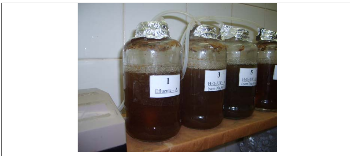
Figura 5.27 Visualização dos reatores aeróbios que receberam efluentes do RAHLF tratados e não tratados quimicamente pelos processos H 2 O 2 /UV e UV.
