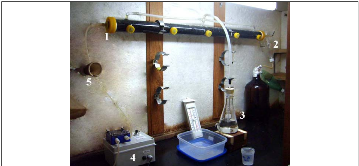
Figura 4.2 Visualização do reator anaeróbio horizontal de leito fixo. Notação: (1) afluente, (2) efluente, (3) selo hídrico, (4) bomba peristáltica, (5) controlador de temperatura.
