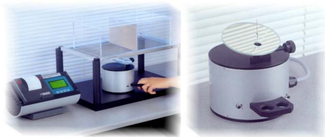
Figura 4— Foto do equipamento utilizado no teste de pressão crescente na pata de ratos. A foto apresenta o estesiômetro dinâmico plantar (modelo 37400; Ugo Basile, Milão, Itália), as caixas de acrílico, o assoalho em rede de malha utilizados no teste de pressão crescente na pata de ratos.
