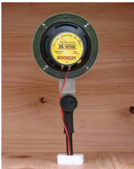
FIGURA 8 Pedestal para microfone adaptado para apoiar o alto-falante.
