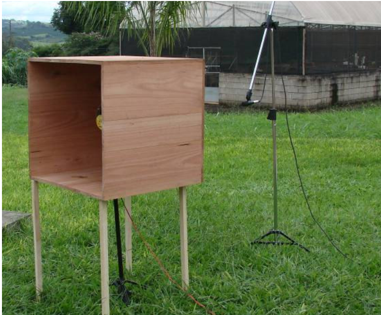
FIGURA 7 Montagem utilizada para realização do ensaio com a barreira acústica de madeira ainda sem a tampa.
