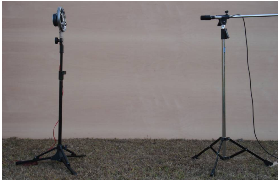
FIGURA 6 Montagem do equipamento para a caracterização da fonte sonora
