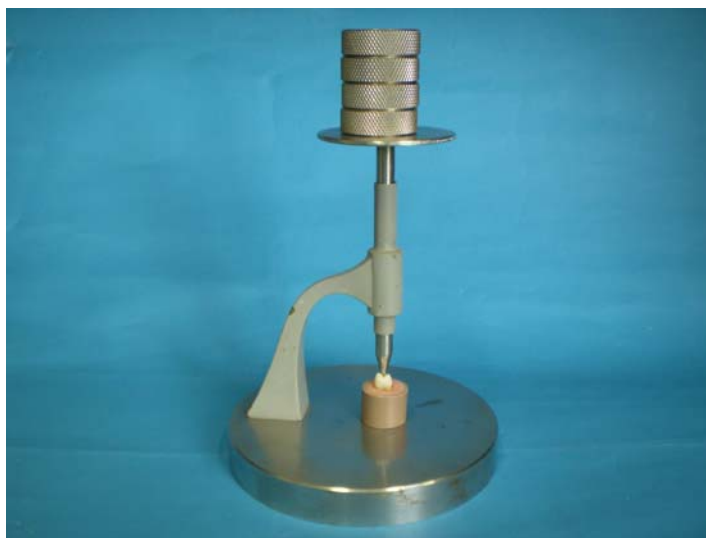
Figura 8: Dispositivo para padronizar a pressão de cimentação
