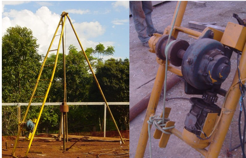
Figura 3.3 – Tripé de cravação e detalhe do sistema de içamento
