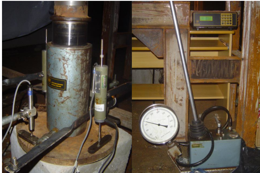
Figura 3.26 – Extensômetros elétricos (LVDT), bomba de alimentação e macaco hidráulico 01
