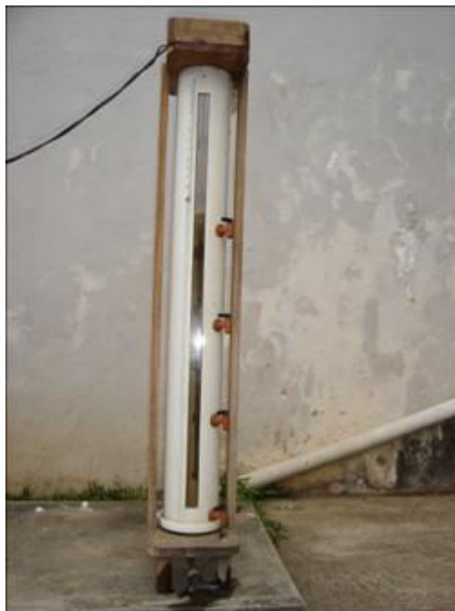
Figura 5.2: Coluna de sedimentação utilizada nos ensaios de clarificação da água de lavagem de filtros.
