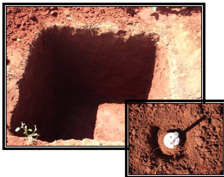
Figura 04: Trincheira para coleta de amostras utilizadas na determinação das características físicas do solo com detalhe do coletor de amostras. Santiago, RS, 2005.
