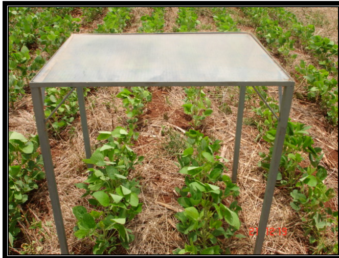
Figura10: Mesa utilizada na determinação da superfície coberta pelas plantas em períodos decendiais. Santiago, RS, 2006.
