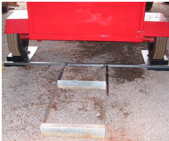
Figura 8 Gabarito desenvolvido por NASCIMENTO (2005) e utilizado para a centralização do simulador de chuvas na parcela.
