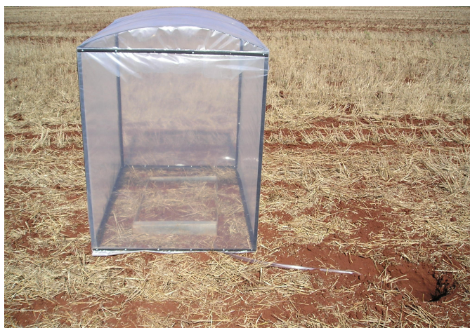
Figura 6 Mini-estufa, calha e mangueira para a coleta do escoamento.
