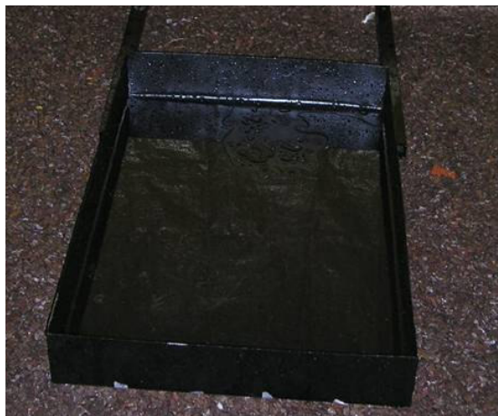
Figura 7 Bandeja utilizada na calibração do simulador de chuvas.
