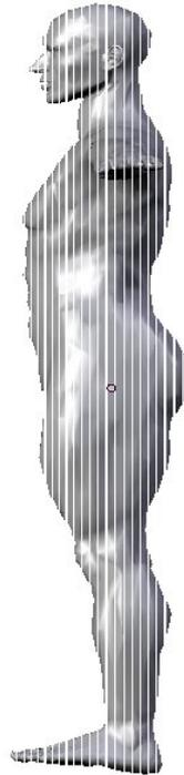
Figura 3.22: Seccionamento do modelo proporcional em vinte e três fatias, utilizando uma espessura de corte cinco vezes maior do que a espessura usada na simulação.
