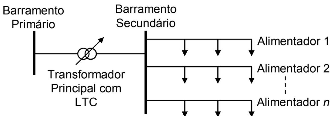
FIGURA 1.3 – Subestação de distribuição do estudo.
