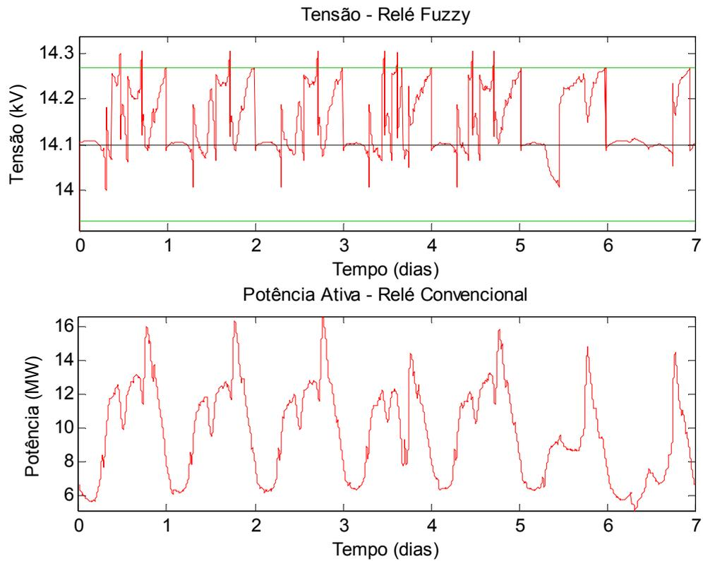
FIGURA 5.4 – Perfil de tensão em carga pesada para Votuporanga 1 (transformador 1).
