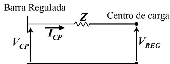
FIGURA 2.3 – Centro de carga para uma condição de carga pesada.
