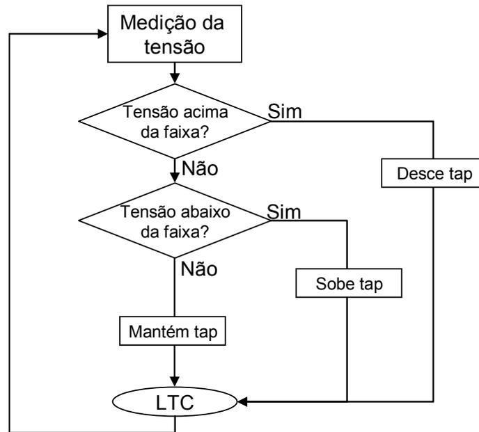
FIGURA 2.7 – Fluxo de execução do AVR.
