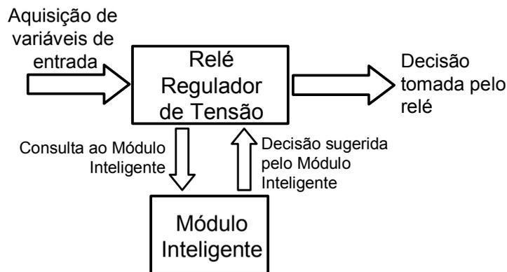
FIGURA 1.4 – Relé regulador de tensão com módulo inteligente.
