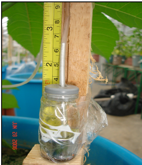
Figura 8. Coluna de mercúrio para monitoramento do o conteúdo de água no solo, casa de vegetação Embrapa/Algodão, Campina Grande-PB, 2006
