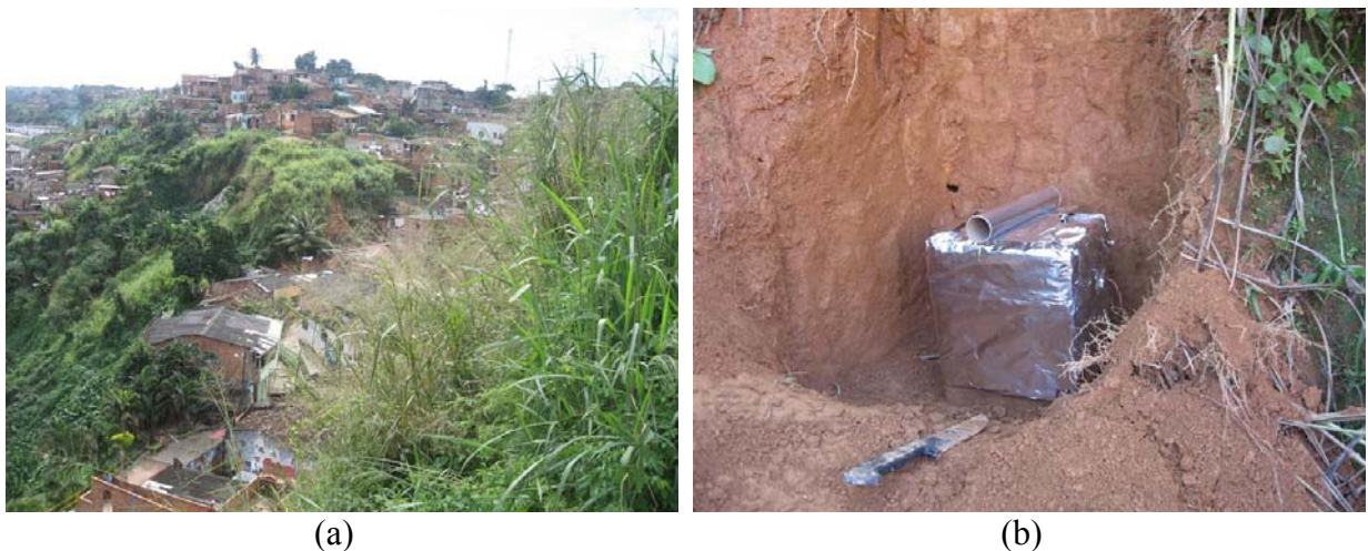
Figura 4.3 – Vista geral do local da retirada da amostra (a) e amostra indeformada (b).
