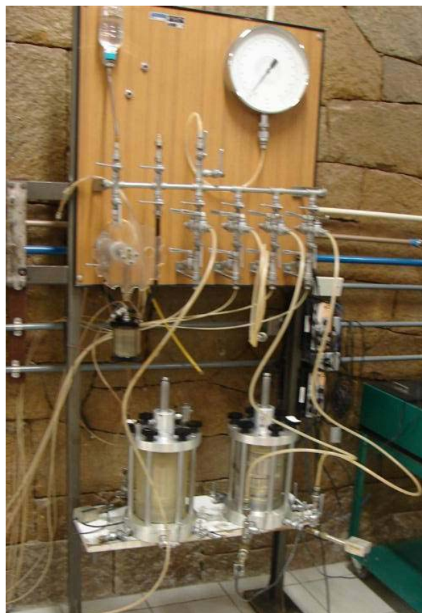
Figura 4.5 – Sistema de saturação da amostra.
