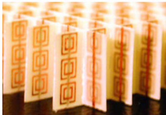
Fig. 1.4 – Estrutura desenvolvida por Shelby et al. em [7] para obter um meio isotrópico com refração negativa.
