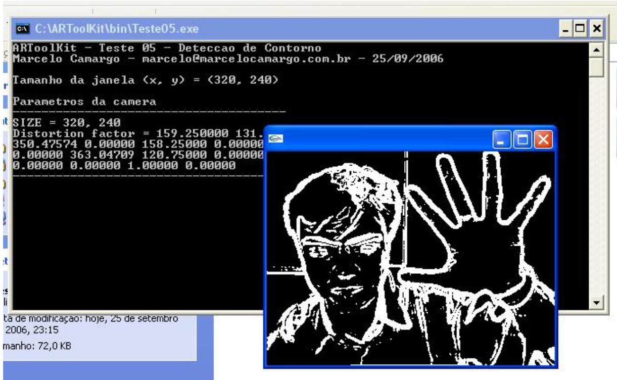
*Figura 30 - Experimento realizado com filtro Sobel*
