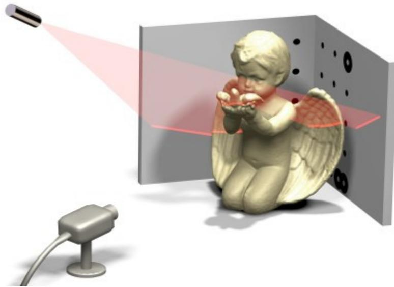
*Figura 01 - Scanner 3D com raio laser*
