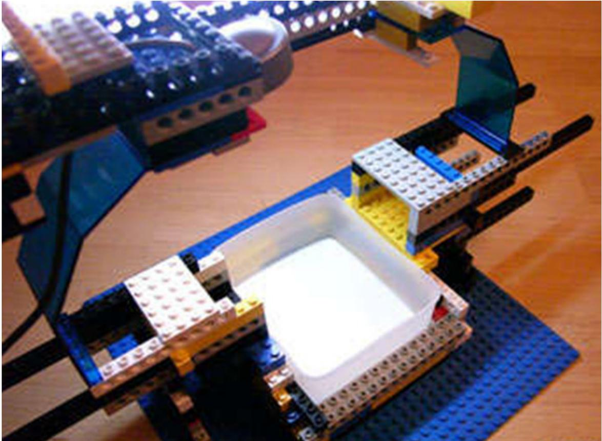
*Figura 03 - Protótipo de escaner com emulsão em líquido*
