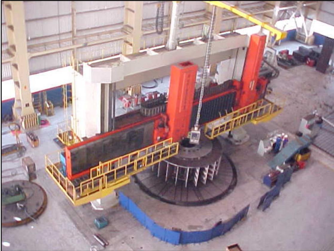
**Figura 2.2:** Processo de usinagem em um torno vertical.
