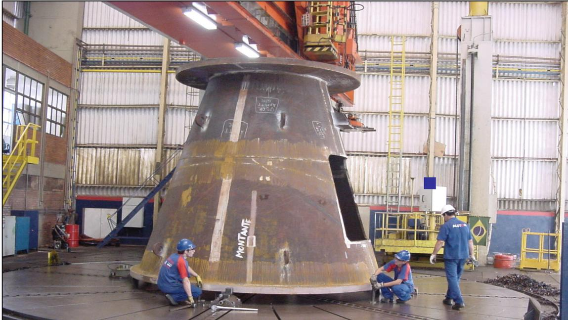
**Figura: 2.1-** Preparação (fixação, centragem, nivelamento) de peça na placa de um torno vertical.
