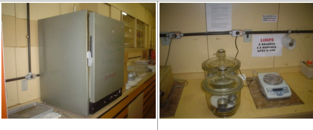
Figura 3 - Estufa para determinação do teor de umidade (A); Balança analítica de marca P-1200 METTLER, com 0,0001 de precisão e dessecador (B)
