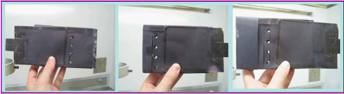
Figura 4.15 - Máscara escura com os espaços de irradiação por grupo experimental
