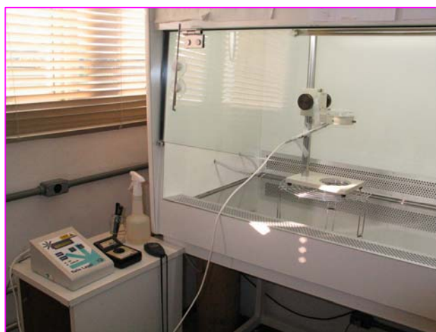
Figura 4.16 - Suporte desenvolvido no laboratório de Cultura de Células do Departamento de Dentística para aplicação padronizada do laser nos poços (Capela de fluxo laminar com suporte para a irradiação do laser e placa pronta para ser irradiada)
