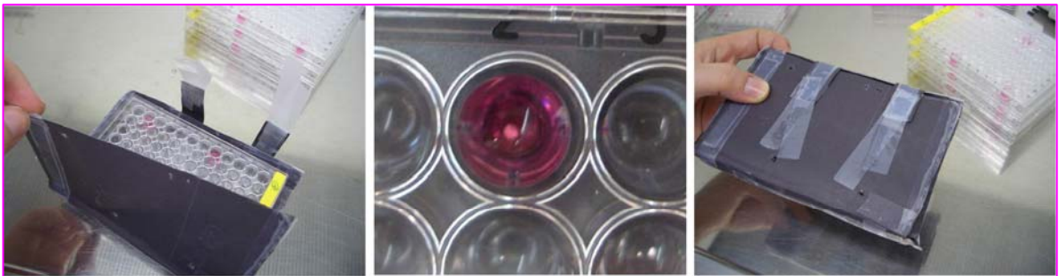
Figura 4.22 - Colocação da máscara escura com checagem se o posicionamento estava certo, com o centro do orifício do laser no meio do poço experimental
