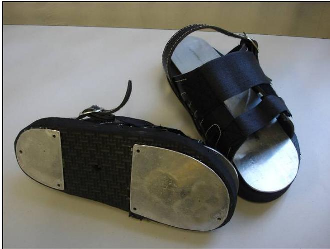
Figura 2.13 – Sandálias com chapa metálica sob o solado e palmilha metálica
