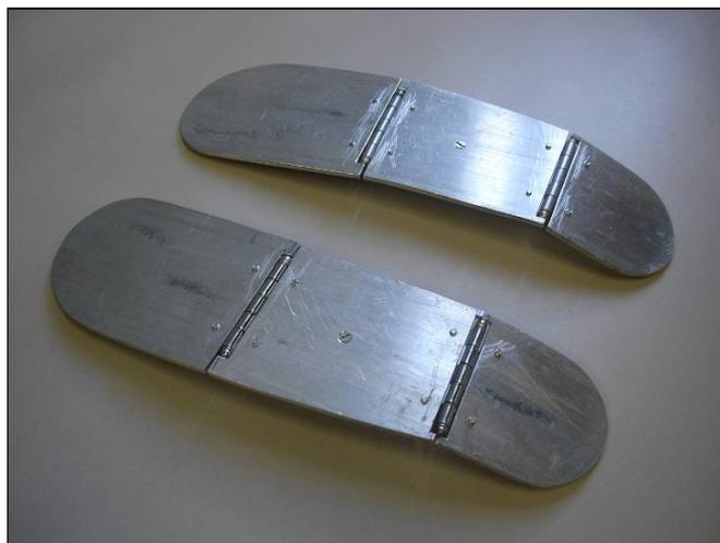
Figura 2.14 – Detalhe das palmilhas metálicas
