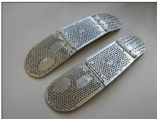
Figura 2.15 – Palmilhas metálicas após furos para alívio de peso
