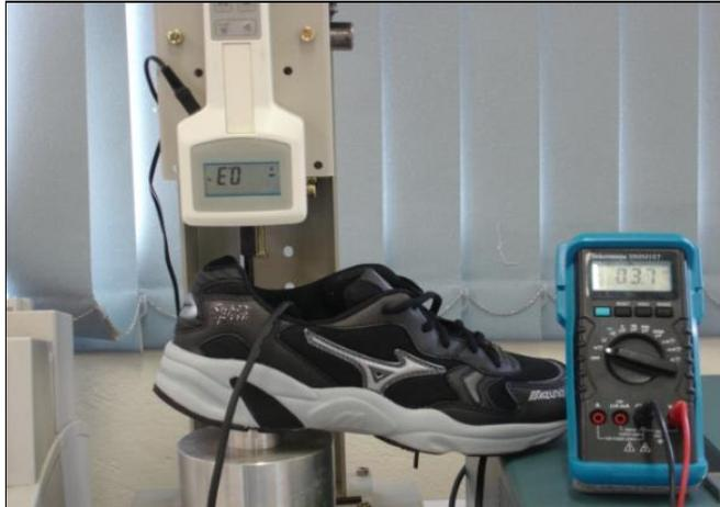
Figura 4.4– Calibração da palmilha instrumentada
