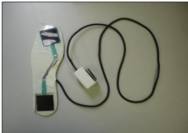
Figura 4.2 – Palmilha instrumentada utilizando FSR
