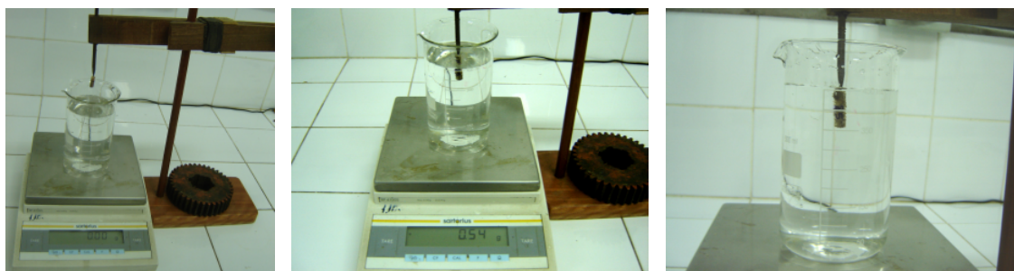
Figura 16 – Determinação do volume da amostra pelo método de imersão.
