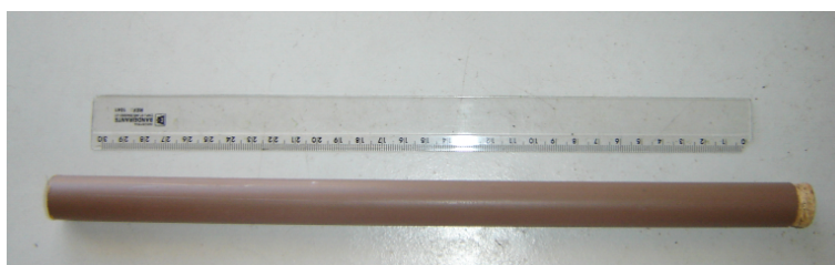
Figura 13 – Recipiente construído para acondicionar as amostras de madeira.
