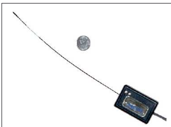
Figura 4.19 - Shape Sensors TM – sensores baseados no uso de fibras ópticas (MEASURAND,2005)
