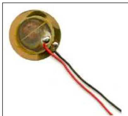
4.22 - Cerâmica piezelétrica usada em dispositivos sonoros conhecidos como “buzzers” (CUNHA,1999)
