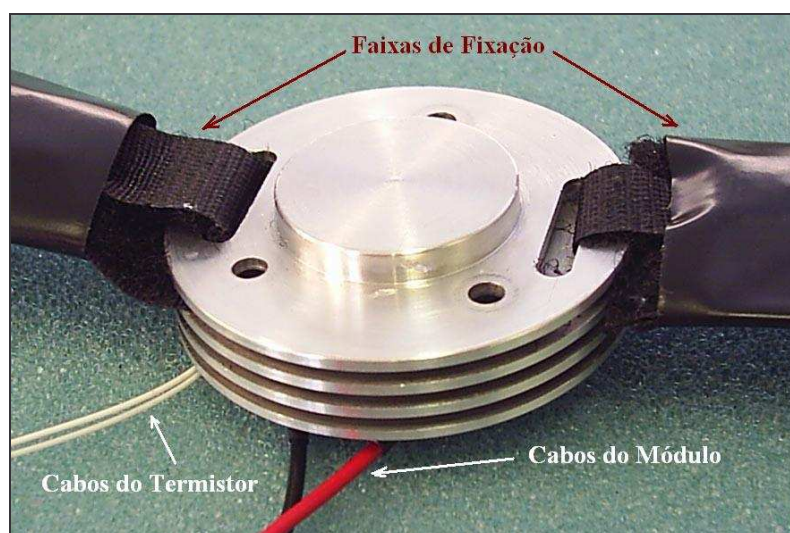
Figura 5.23 - Reservatório térmico montado com faixas de fixação, termistores para controle e Módulo Peltier instalados
