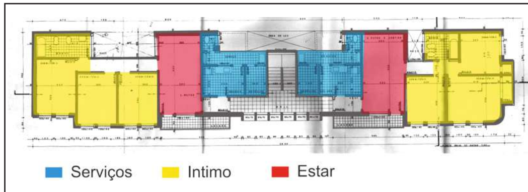
Figura 6.62 Planta de edificação. Usos. Fonte: O autor
