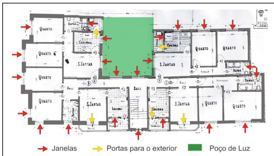
Figura 6.95 Planta de edificação. Ventilação. Fonte: O autor
