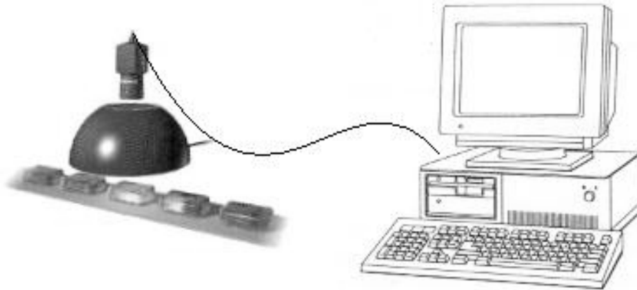
Figura 4. 1 - Sistema de visão computacional para análise das bolsas para coleta de sangue.
