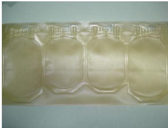
Figura 2. 3 - Placa já estampada e soldada.
