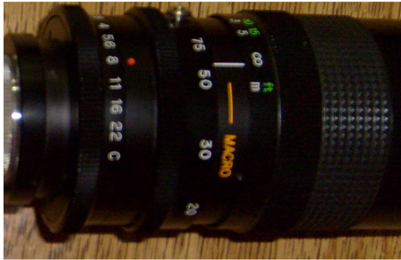
Figura 4. 10 - Ajustes do conjunto de lentes macro zoom.
