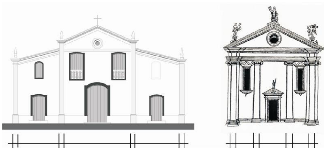
Ilustração 12 – Fachada São Francisco de Paula e Fachada de Cesare – espaçamento entre colunas
