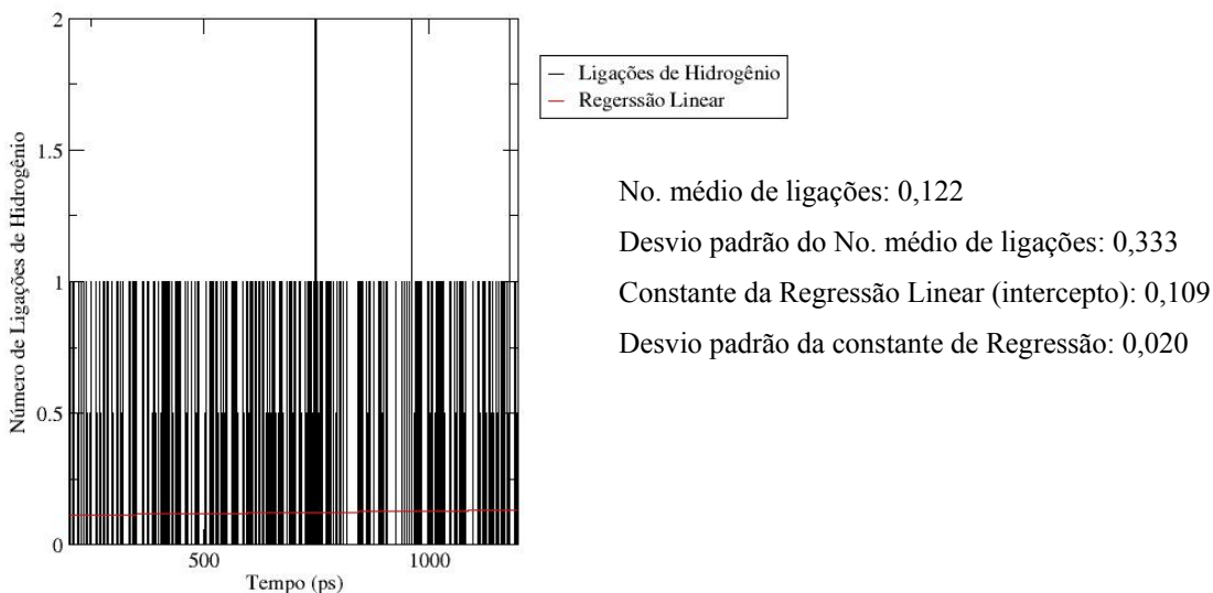
Fig. 50. Gráfico das Ligações de Hidrogênio com o primeiro conjunto de cargas (cargas originais) do H da hidroxila com os oxigênios das moléculas de água.
