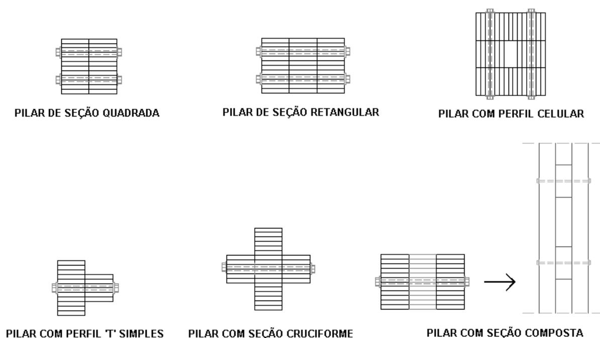
Figura 71: Algumas possibilidades de pilares com elementos lineares de bambu laminado colado.
