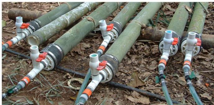
Figura 24: Método Boucherie para o tratamento dos bambus.
