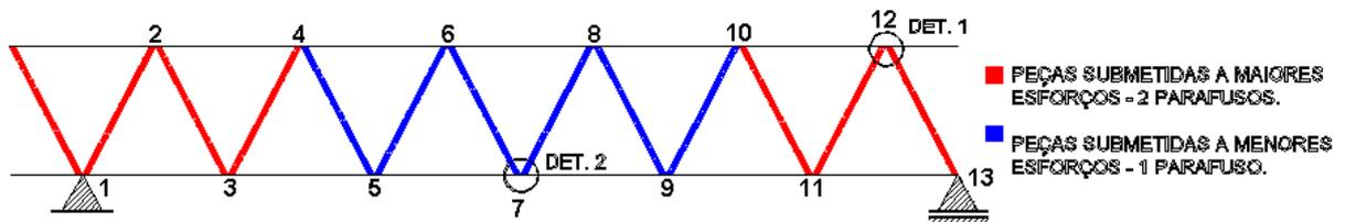
Figura 81: Esquema de distribuição dos parafusos conforme a solicitação nas barras.
