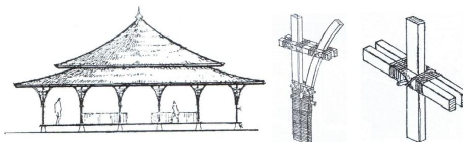
Figura 49: Fachada da mesquita e os detalhes da uniões das lâminas.
