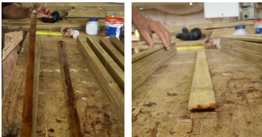
Figura 88: Aplicação do adesivo e alinhamento das lâminas.
