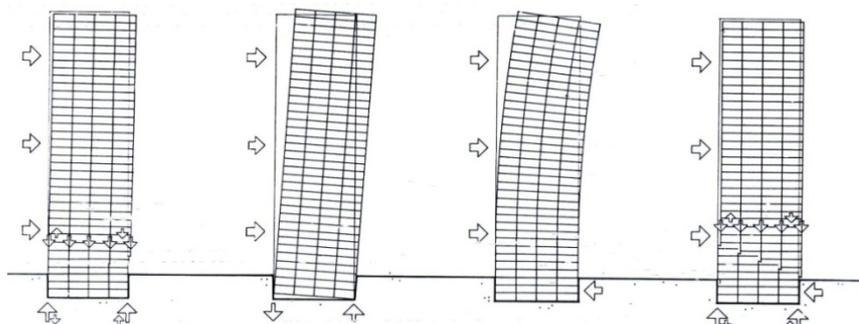
Figura 06: Exemplo da redistribuição dos esforços no sistema de altura-ativa.
