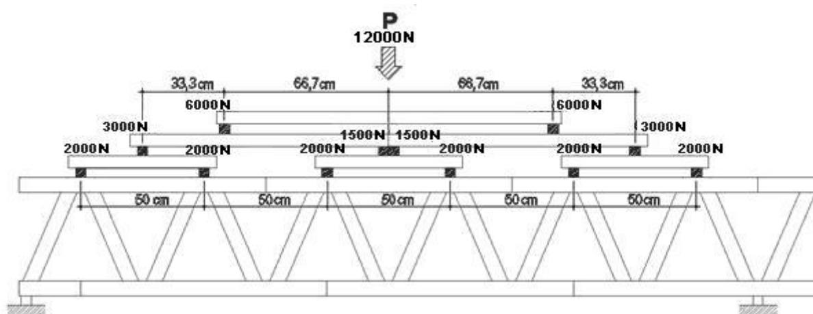
Figura 102: Sistema de barras para distribuição uniforme das cargas aplicadas.
