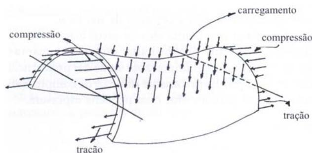
Figura 05: Exemplo da redistribuição dos esforços no sistema de superfície-ativa do tipo casca.
