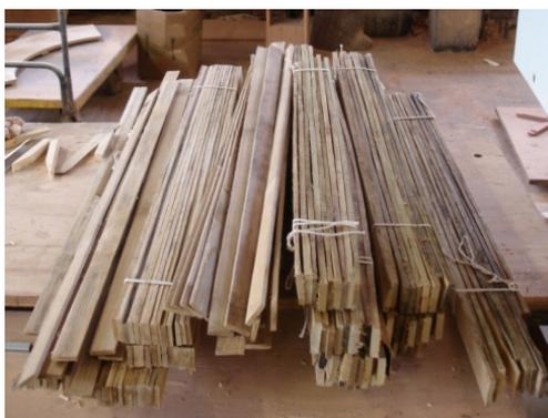
Figura 87: Agrupamento das lâminas em lotes de acordo com as suas dimensões.
