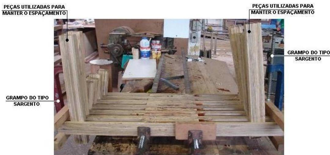
Figura 95: Elementos compostos na prensa a frio.
