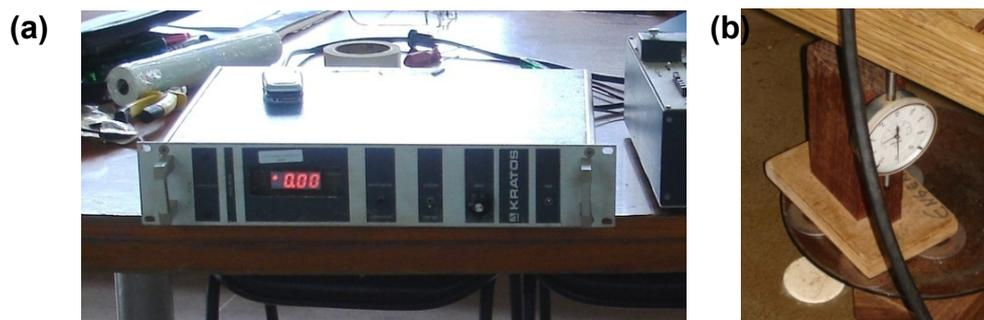
Figura 101: (a) Medidor portátil e (b) extensômetro já posicionado na estrutura.
