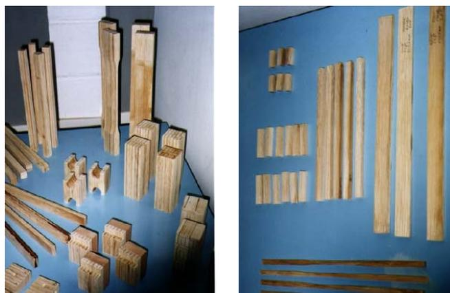
Figura 59: Amostras de bambu para ensaio de resistência mecânica.
