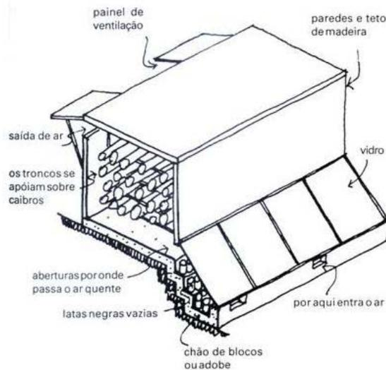
Figura 23: Armazém com aquecedor solar para secagem dos bambus.
