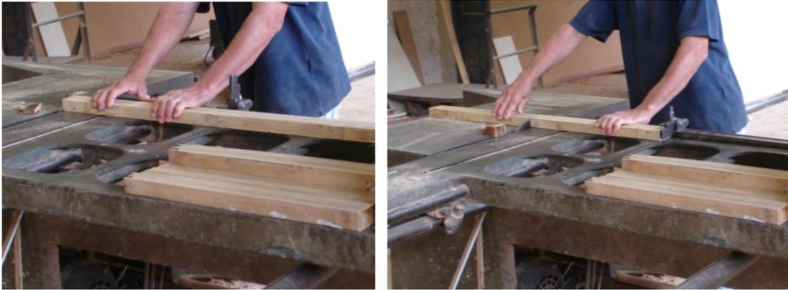
Figura 93: Elementos trabalhados na serra circular de bancada.
