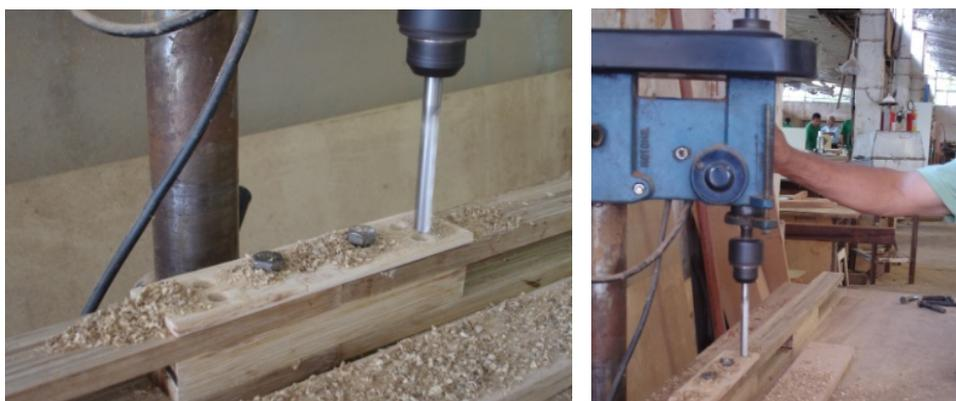
Figura 97: Método de perfuração com gabarito usado na furadeira de bancada.
