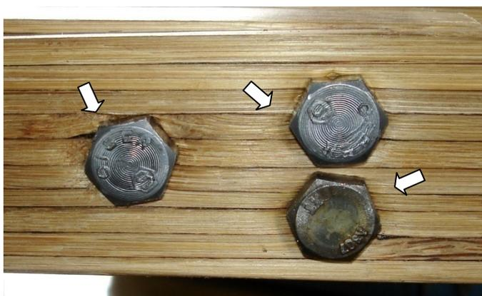
Figura 107: Fibras do bambu esmagadas pela cabeça dos parafusos.
