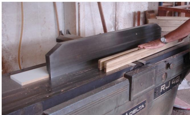
Figura 96: Nivelamento das superfícies dos elementos compostos na desempenadeira.
