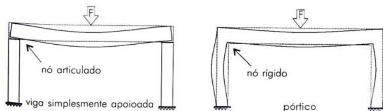
Figura 04: Exemplo da redistribuição dos esforços no sistema de seção-ativa do tipo viga e pórtico.
