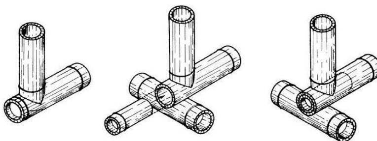
Figura 40: Maneira de evitar o esmagamento das peças em ligações de bambu.
