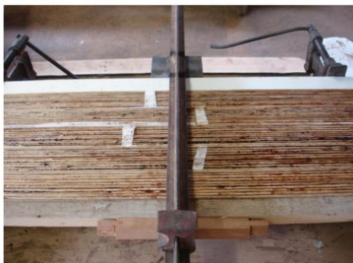
Figura 89: Lâminas na prensa a frio do tipo trilho-sargento.
