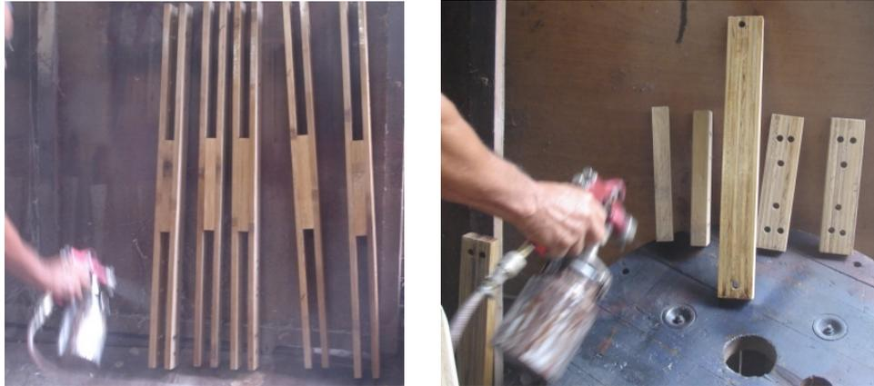
Figura 99: Acabamento final com a aplicação do selador.
