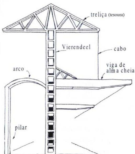
Figura 07: Associação de diferentes elementos para composição dos sistemas estruturais.
