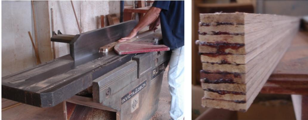
Figura 91: (a) Componentes na desempenadeira e (b) Após o processo com 1 face plana.
