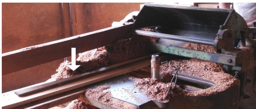
Figura 86: Saída da lâmina da plaina desengrosso de 1 face - retirada da casca.
