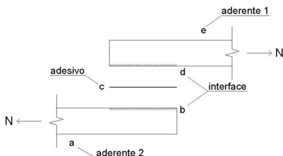
Figura 61: Elementos de uma ligação.
