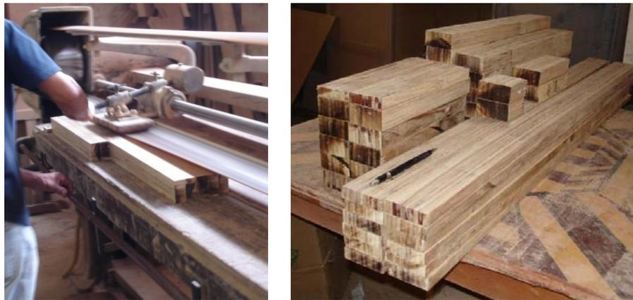
Figura 94: Peças na lixadeira elétrica e já prontas com os primeiros acabamentos.
