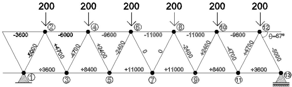
Figura 78: Determinação dos esforços atuantes nas barras da treliça.
