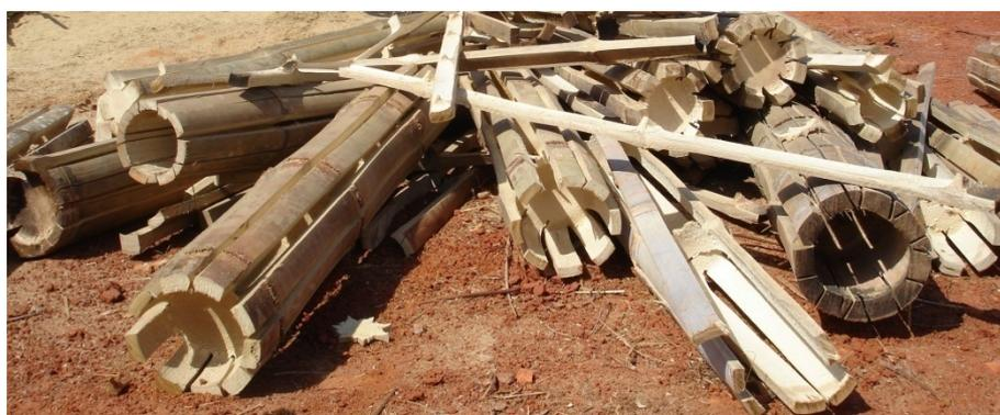
Figura 83: Colmos da espécie *Dendrocalamus giganteus* após passarem pela serra de discos duplos.
