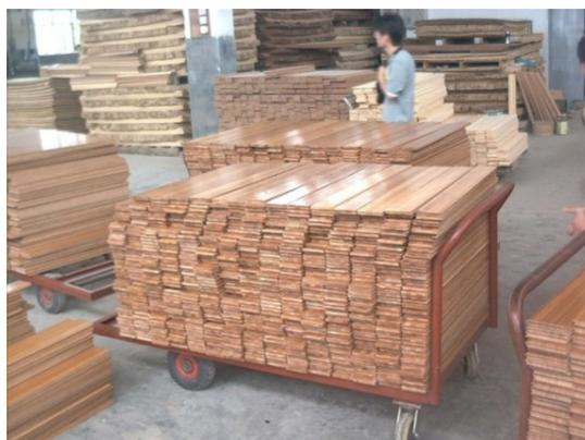
Figura 57: Fábrica de pisos laminados colados de bambu na China.
