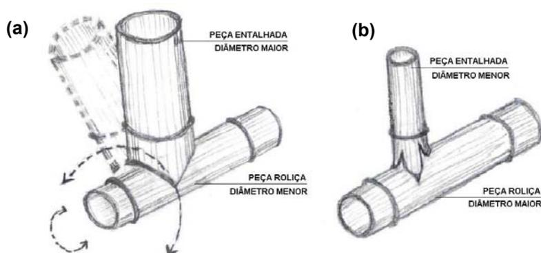
Figura 44: (a) Tendência de rotação pela diferença de diâmetro entre as peças.
