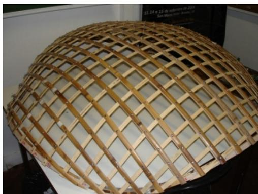
Figura 47: Protótipo da calota achatada de bambu ripado em malha retangular quadrada.
