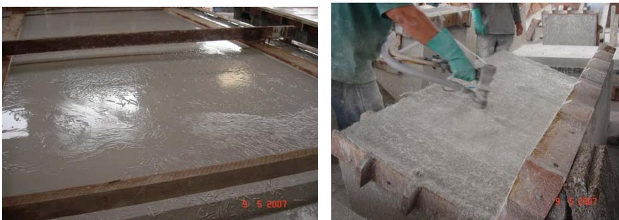
Figura 71 – Fôrma para painel em CAD e injeção de fibras de vidro no GRC
