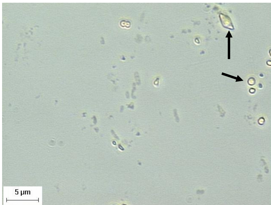
Figura 38. Microscopia óptica de luz comum destacando a presença de cristais de enxofre
