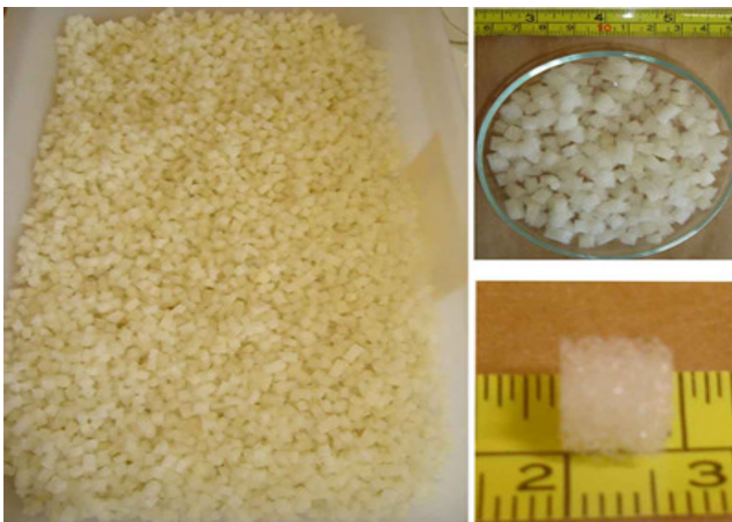
Figura 7. Espuma de poliuretano cortadas em cubos de 5 mm.
