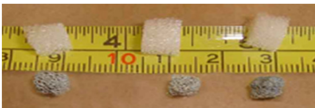
Figura 48. Foto comparativa da redução de tamanho das espumas.
