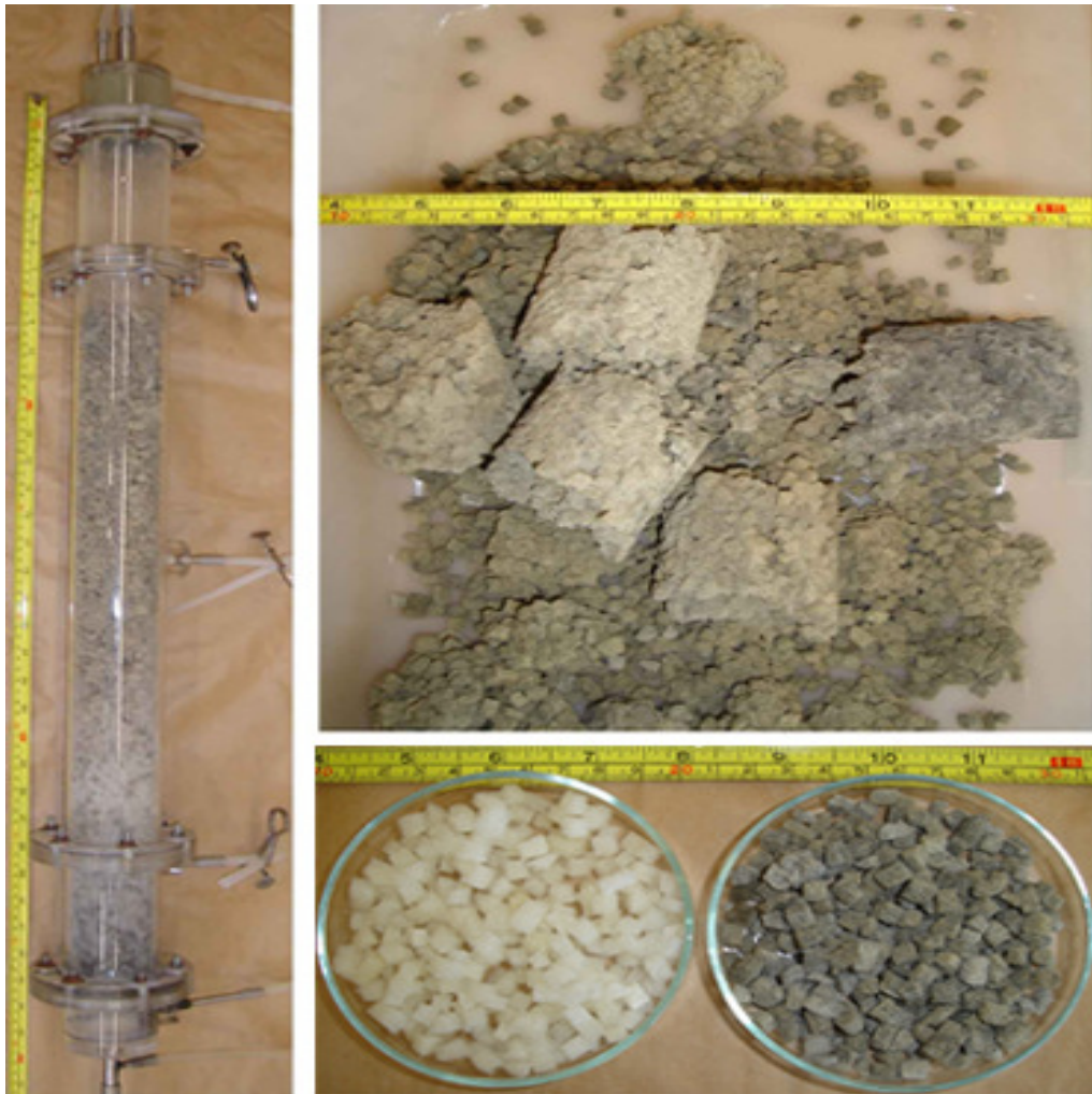
Figura 46. Fotos das espumas utilizadas no biofiltro.
