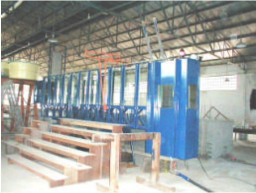
Figura 5.1: Canal bidimensional de geometria simplificada na configuração original.
