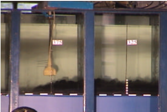
Figura 7.10: Imagem da corrente simulada no ensaio 10 obtida por câmera de vídeo.
