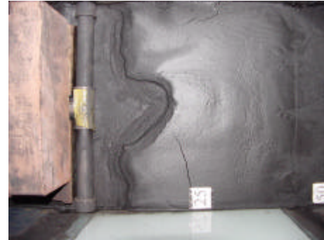
Figura 6.30: Imagem em planta de depósito gerado pelo ensaio 18 (3ª fase)
