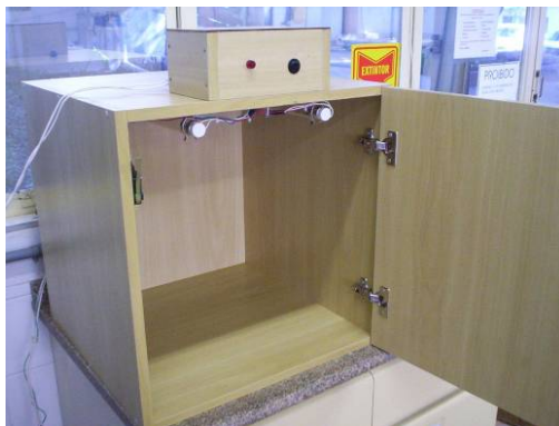
Figura 4.6 – Vista geral da câmara de radiação ultravioleta
