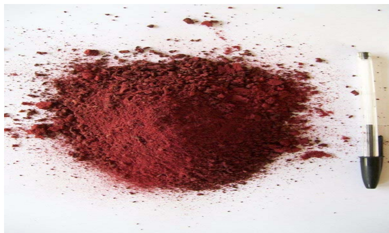
Figura 6. Produto farináceo resultante da trituração de fatias de beterraba desidratadas. Laboratório de Tecnologia de Alimentos, Departamento de Engenharia de Alimentos, UEPG, Ponta Grossa, Paraná, 2007.
