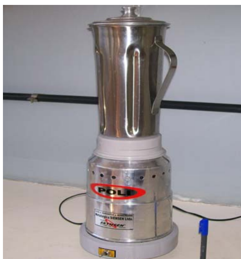
Figura 2. Triturador industrial, de facas. Laboratório de Tecnologia de Alimentos, Departamento de Engenharia de Alimentos, UEPG, Ponta Grossa, Paraná, 2007.
