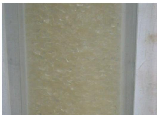
Figura 4.5 - Partículas de poliestireno no reator de leito fluidificado.
