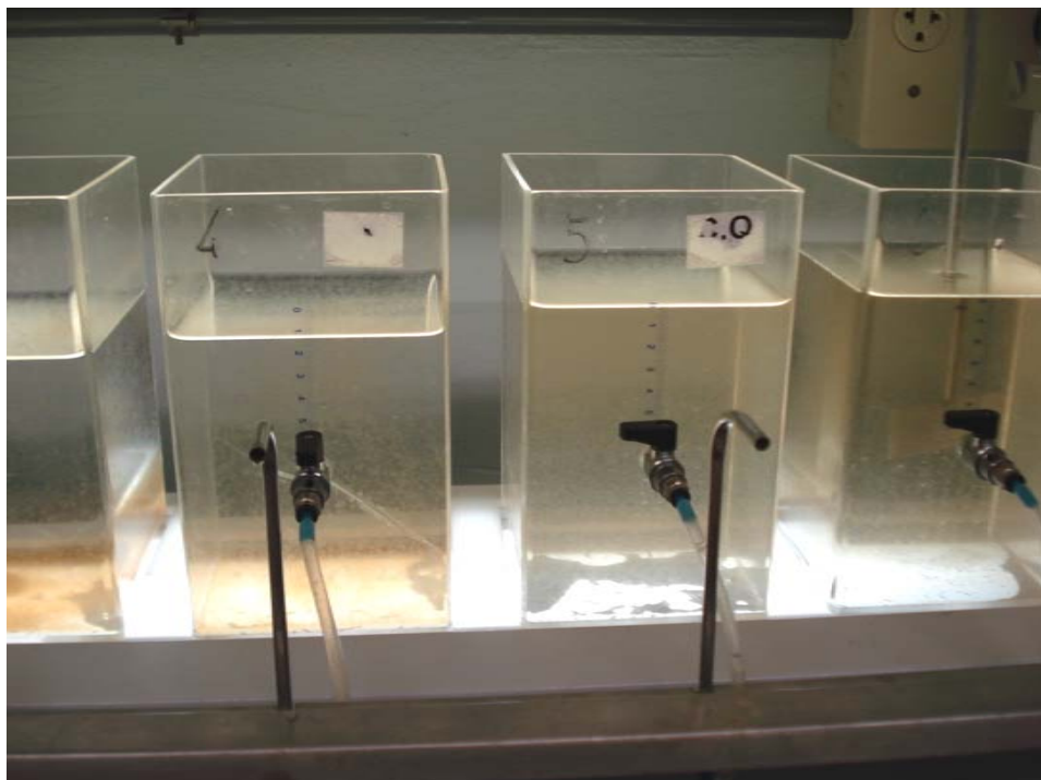
Figura 5.25 – Vista frontal dos jarros durante um ensaio. Observa-se o primeiro jarro ao final da sedimentação, o segundo no início da sedimentação e o terceiro ainda refloculando.
