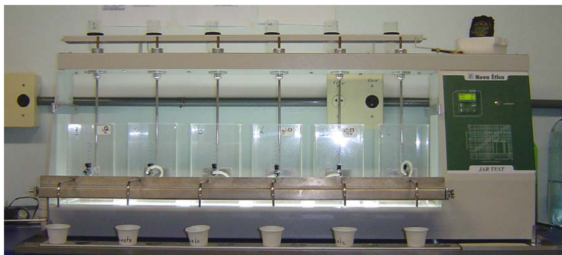
Figura 4.2 – Foto do equipamento Jarteste (reator estático de bancada).
