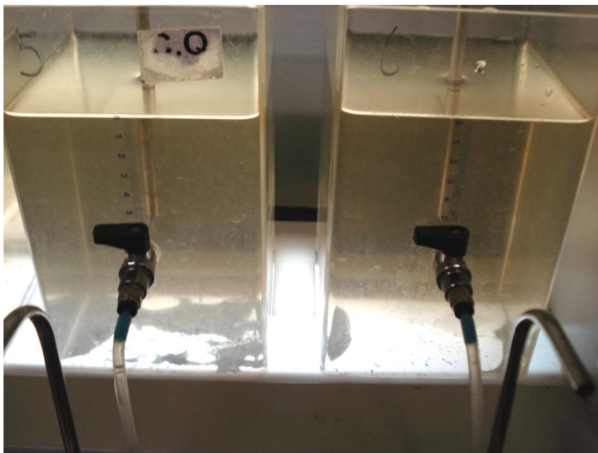
Figura 5.18 – Vista frontal dos jarros mostrando os flocos após a ruptura, para o gradiente de velocidade de ruptura de 150 \text{ s}^{-1}
