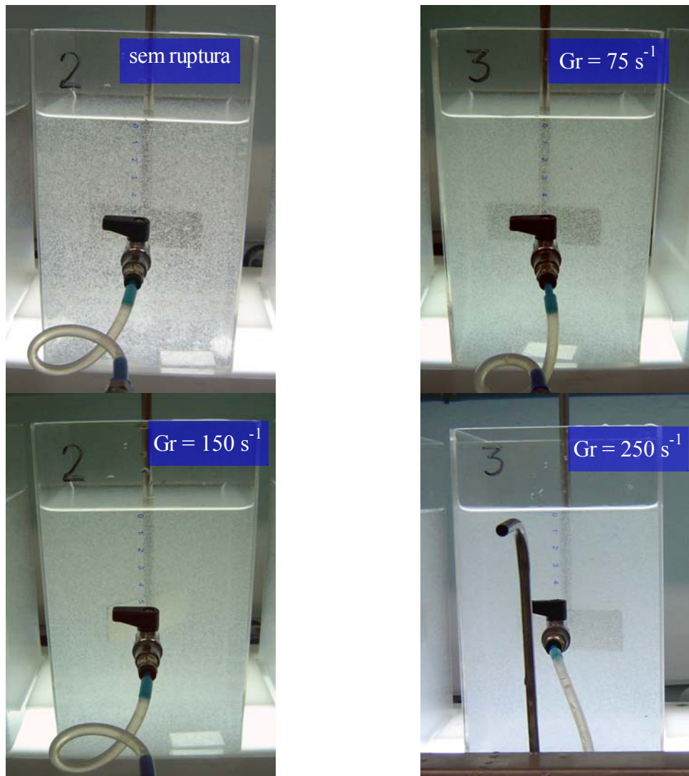
Figura 3.13 – Vista frontal do jarro mostrando os flocos ao final da floculação e após a ruptura, para os gradientes de velocidade de ruptura de 75, 150 e 250 s -1 Fonte - VOLTAN (2007)
