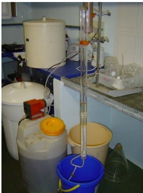
Figura 4.5 – Foto da Instalação de Extração das SHA
