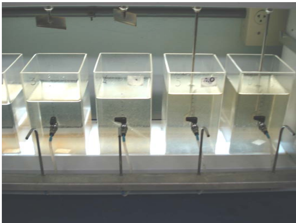
Figura 5.20 – Vista frontal dos jarros durante o ensaio para G_r igual a 50 \text{ s}^{-1} e G_{rf} igual a 10 \text{ s}^{-1} . Observa-se os dois primeiros jarros ao final da sedimentação, o segundo no início da sedimentação e o terceiro e quarto ainda refloculando.
