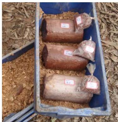
Figura 43: Amostras indeformadas prontas para transporte.
