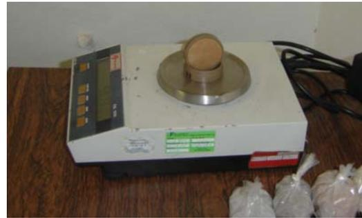
Figura 33: Pesagem da amostra.
