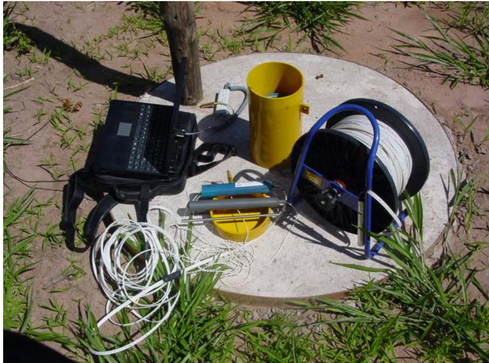
Figura 15: Equipamentos para monitoramento do nível d'água.
