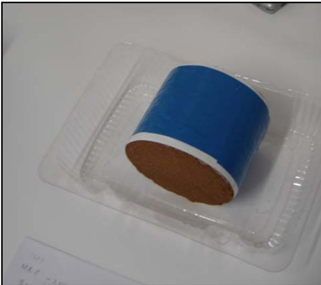
c) Amostra de solo preparada para o ensaio.
