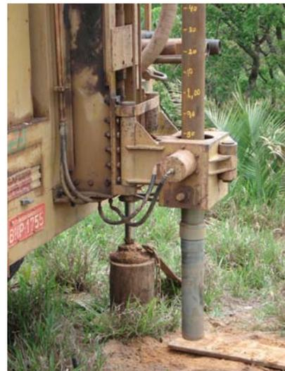
Figura 26: Amostrador tubular acoplado a máquina de perfuração.
