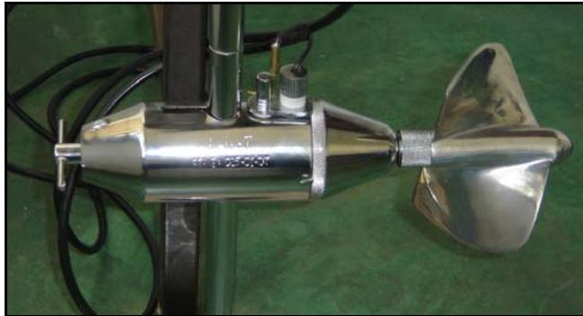
Figura 18: Molinete hidrométrico marca JCTM modelo MLN-7.
