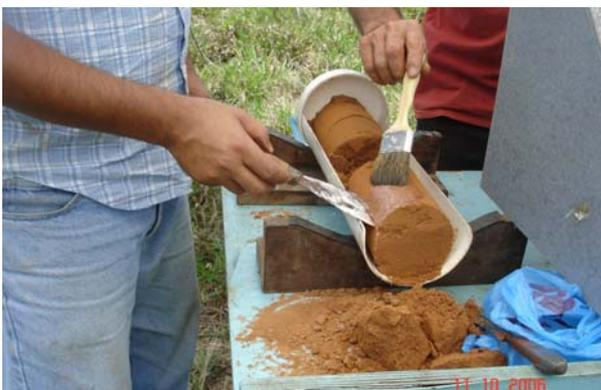
Figura 42: Tratamento e aplicação de parafina na amostra de solo indeformada.
