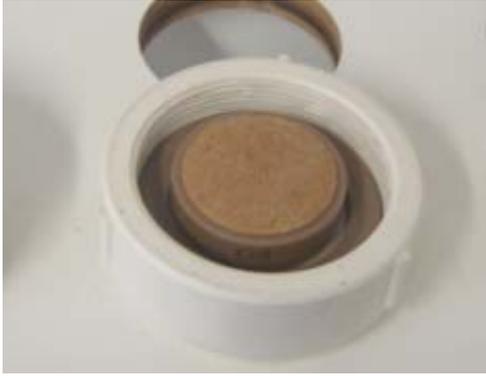
Figura 35: Amostra colocada no funil.
