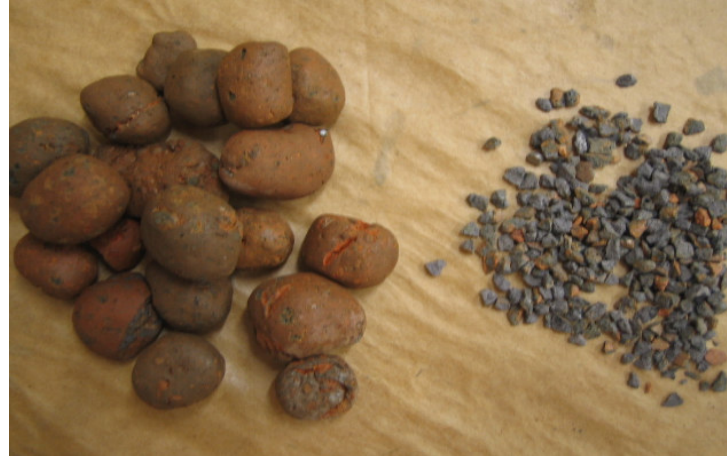
Figura 4.1. Partículas de cinasita para utilização como suporte para aderência das populações microbianas. (a) sem tratamento, (b) com tratamento.
