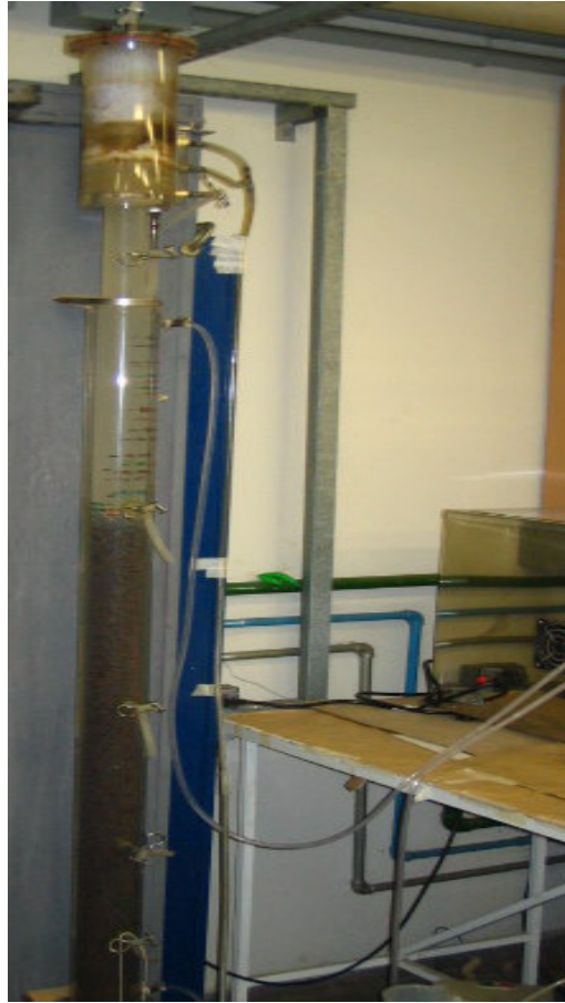
Figura 4.3. Fotografia do reator anaeróbio de leito fluidificado utilizado nesse estudo sob operação.
