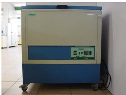
Figura 4.12: Agitador de amostras em temperatura constante.
