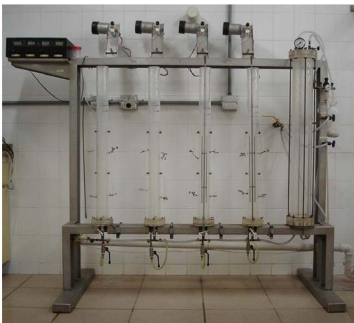
Figura 4.3: Flotateste.
