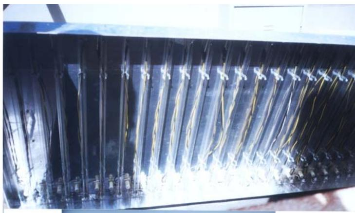
Figura 8 – Módulo (placa) de lâmpadas germicidas.
