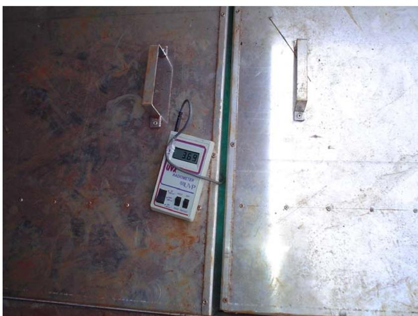
Figura 11 - Radiômetro realizando medição da intensidade de radiação UV.
