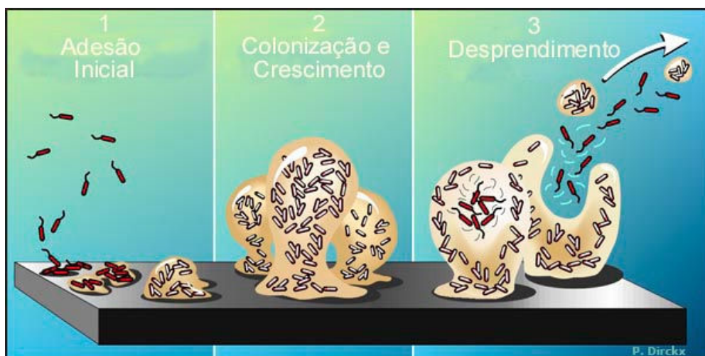
Figura 3.1 - Desenvolvimento do biofilmes em três etapas: Adesão inicial, colonização e crescimento e desprendimento do biofilme com dispersão do material biológico (Adaptado de Stoodley e Dirckx, 2003).
