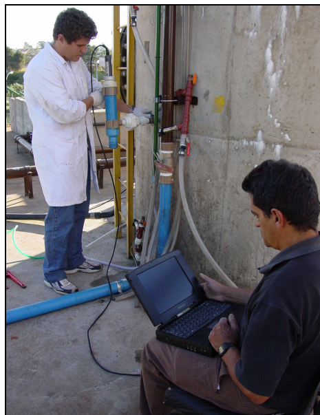
Figura 4.24 - Amostragem com equalizador de pressão e armazenamento de dados (OD, POR, pH e temperatura) em microcomputador.
