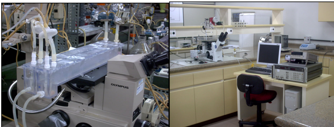
Figura 4.32 - Montagem experimental do reator tipo célula de fluxo sobre microscópio invertido e sistema de aquisição de dados.
