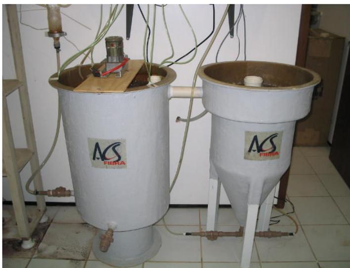
Figura 7. Sistema de lodos ativados utilizado na pesquisa
