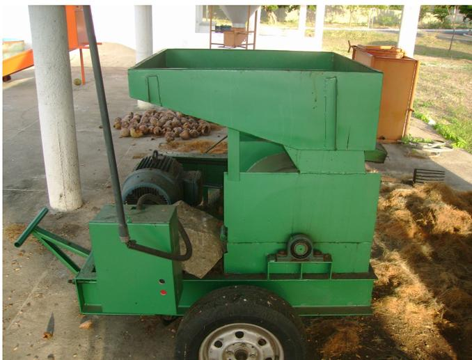
Figura 3. Máquina trituradora de casca de coco verde
