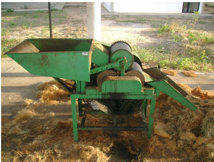
Figura 4. Máquina de prensagem da casca de coco triturada
