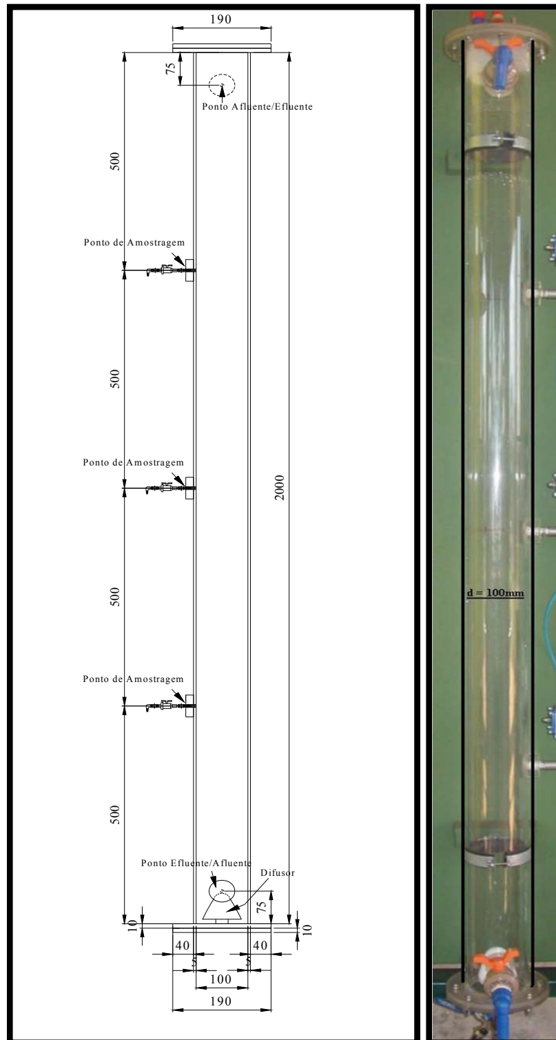
Figura 4. 1 – Desenho e fotografia da coluna de ozonização em acrílico (cotas em milímetro).
