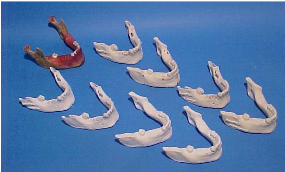
Figura 4.1 - Mandíbula seca e os oito modelos de prototipagem rápida produzidos, sendo quatro no processo de Sinterização Seletiva a Laser (SLS) e quatro no processo de Impressão Tridimensional (3DP)
