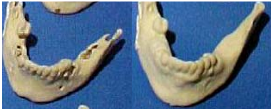
Figura 6.1: Detalhe da reprodução das estruturas dos modelos de prototipagem rápida em 3DP, dos defeitos ósseos resultantes da tomografia volumétrica (esquerda) e tomografia computadorizada (direita).
